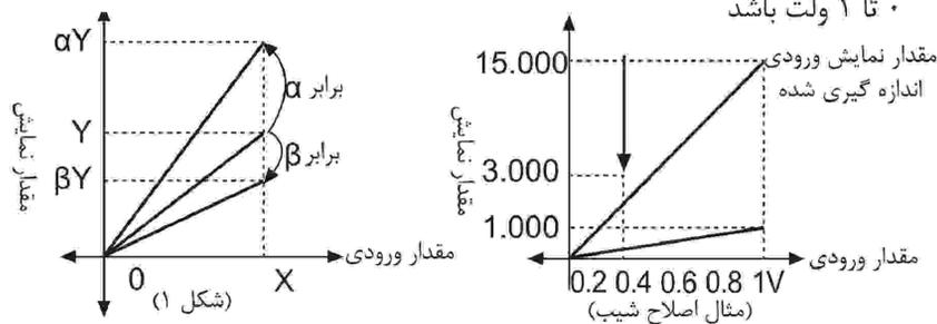
۱- در پارامتر ۱ برای ورودی اندازه گیری مقدار 0-1VDC را انتخاب کنید.
